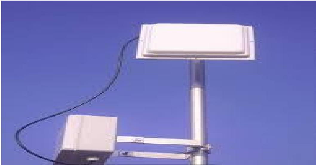
Figura 35. Caja protectora y antena panel
