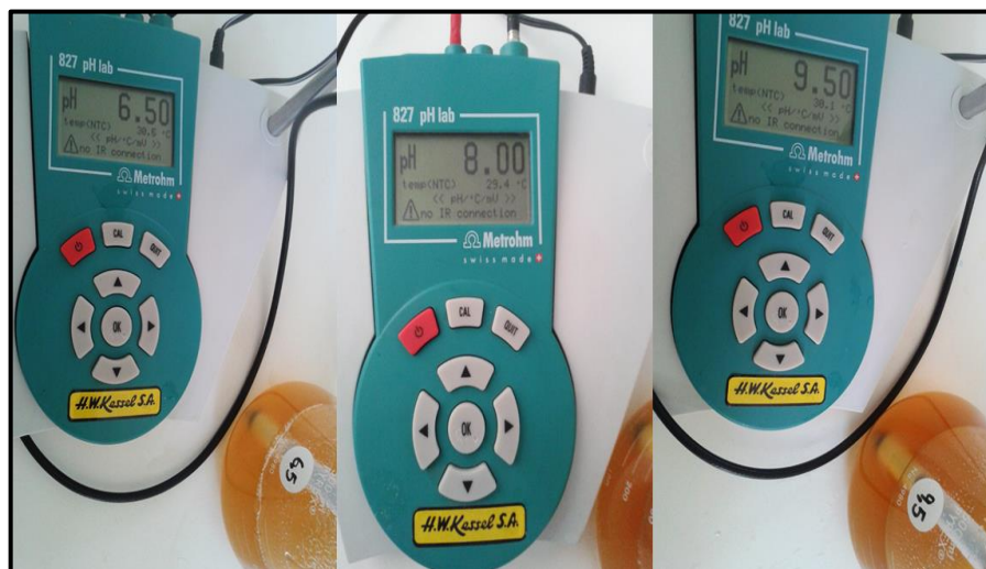
Foto 13: Se acondicionaron los medios de PDA a tres pH (6,5; 8,0; 9,5) con Hidróxido de sodio 1N, luego se llevaron a la autoclave.
